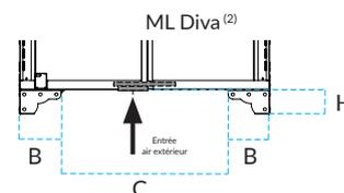
(1) La version avec sortie fumées à gauche est symétrique. La prise d'air est toujours positionnée sous la chambre de combustion.
