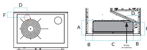
(1) La version avec sortie fumées à gauche est symétrique. La prise d'air est toujours positionnée sous la chambre de combustion.
